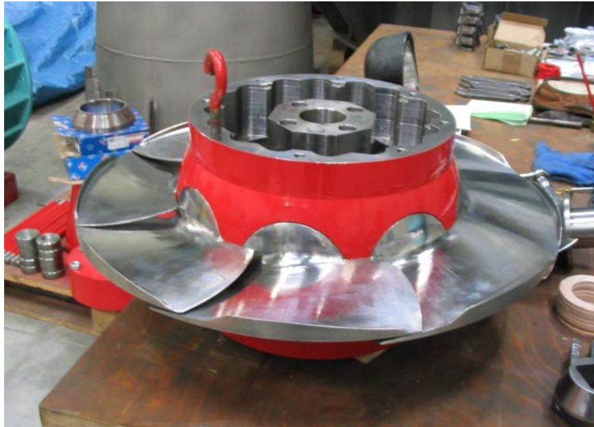
Roue motrice de la turbine axiale de St-Bueil en cours de montage. H = 26.6 \text{ m} , Q = 1.5 \text{ m}^3/\text{s} , D_e = 580 \text{ mm} , 8 pales. On remarquera les lèvres anti-cavitation à la périphérie des pales, destinées à limiter la cavitation marginale.
